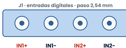
Figura 6. Orden de los terminales de J1 (vista desde arriba, de izquierda a derecha).
