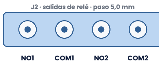
Figura 8. Orden de los terminales de J2 (vista desde arriba, de izquierda a derecha).
