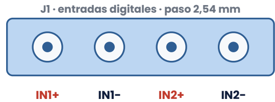
Figura 6. Orden de los terminales de J1 (vista desde arriba, de izquierda a derecha).
